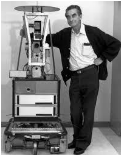
SHAKY 1970 (Σέικι): το shakey είναι το πρώτο κινούμενο ρομπότ που μπορούσε να πραγματοποιεί λογικές διεργασίες.
